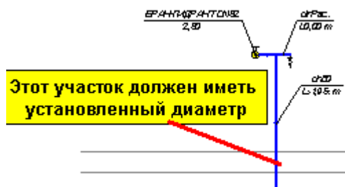
Верхушка противопожарного стояка
